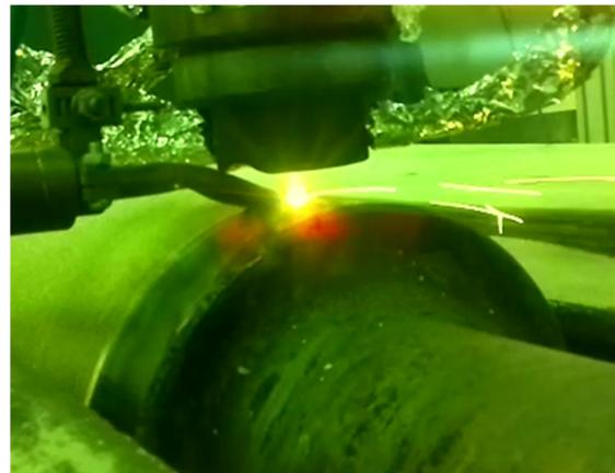
窄带冷轧工作辊的激光熔覆再制造
