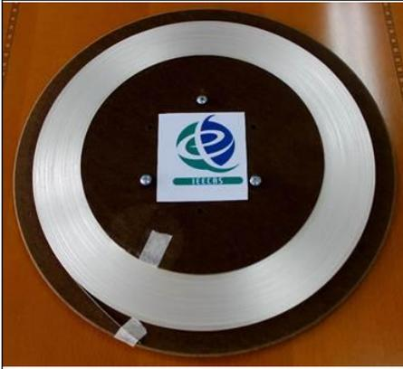
世界第一根 100 米量级铁基超导长线
